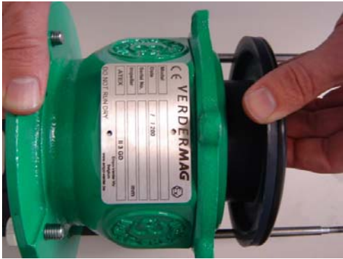
Obrázek 14: Nasazení zadní části rotoru na skříň hnací části čerpadla
