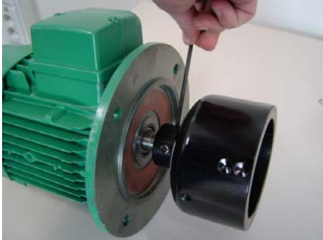
Obrázek 21: Zajištění magnetu pohonu na hřídeli motoru
