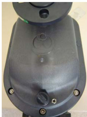
Obrázek 1: Začátek demontáže tělesa čerpadla od tělesa pohonu.
