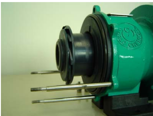
Obrázek 15: Složení magnetického rotoru a vymešovaciho obložení
